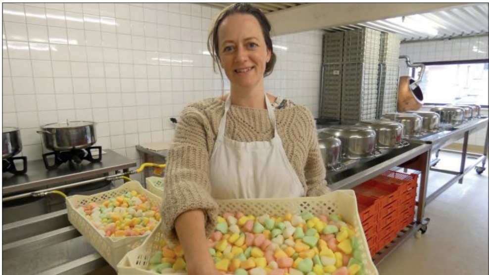
Barbara Bontinck met een doos gekandiseerde hartjes. Nu nog een bodempje van chocolade aanbrengeen en het product is klaar. De kookpotten dienen voor het koken van de kandijsiroop. Hierin wordt de fondant gedompeld, waardoor zich een kristallaagje vormt rond het product.
