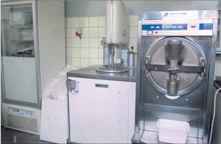
Een blik in het nieuwe roomijsatelier, 1976. Links de roomijsturbine, rechts de turbine voor diepvriesijs. In deze machine kon luchtiger roomijs gemaakt worden, ideaal voor het maken van ijsstaarten. (MT)
