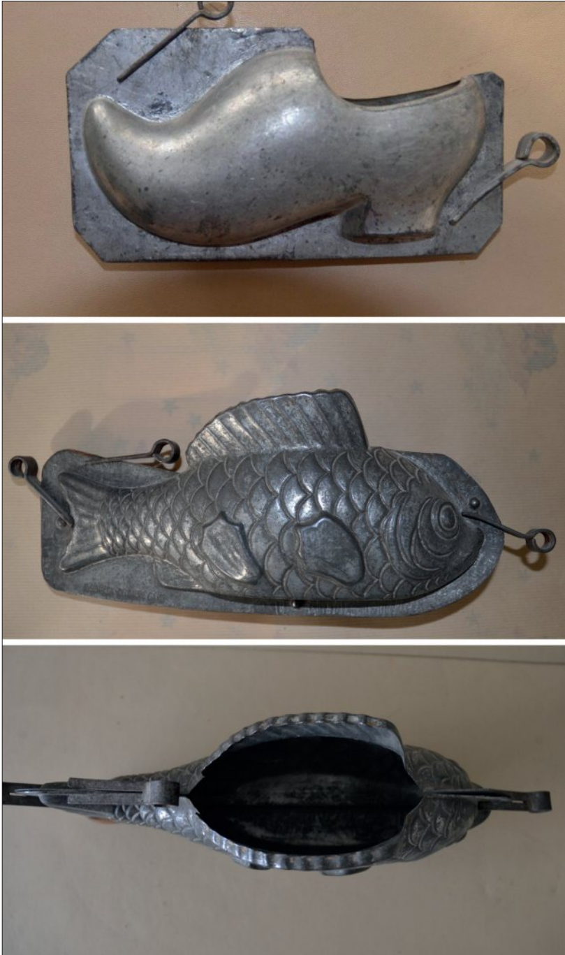
Chocoladevormen, tweedelig, met koppelklemmen (schoen, aprilvis en vis). (Coll. EA). De ambachtelijke chocolatier laat de overtollige chocolade uitvloeien in de vormen tot de gewenste dikte. Na uitharding in een droge koelruimte worden de chocoladestukken uit de geopende vormen gehaald.
