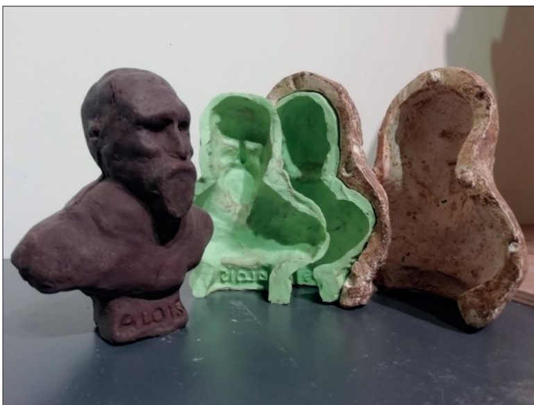
Buste van Aloïs De Beule: soepele siliconenmal ingebed in vaste steunmal. (FDG)
